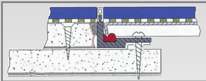
Schnittansicht: 25mm ROTH-Aluprofil mit weißer oder grauer 3 mm Funktionsfuge sowie roter Dichtung und Edelstahlfliesenträgerplatte + bauseitige Imprägnierung + Abdichtung des Rahmens zur Wand.
